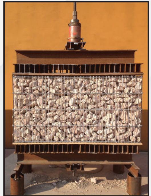
Prova di carico assiale singolo gabbione Single gabion axial load test
