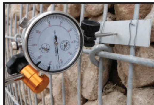
Deformazione misurata in corrispondenza di un "tirante saetta" sottoposto a carico Deformation measured with "tie rod" subjected to load
